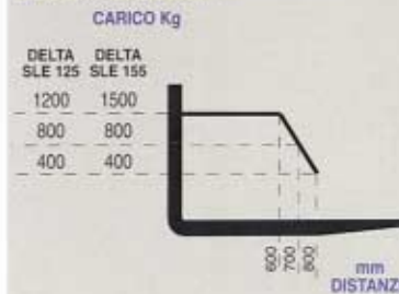
Diagramma rappresentante la variazione di posizione del baricentro dei carichi al variare degli stessi
