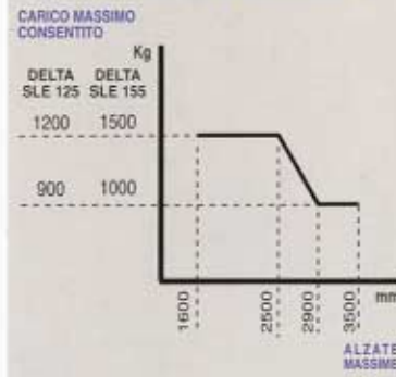
Diagramma rappresentante la variazione di posizione del baricentro dei carichi al variare degli stessi
